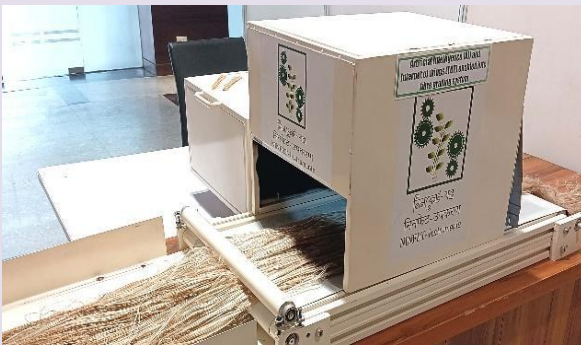
AI & IoT enabled jute grading instrument
